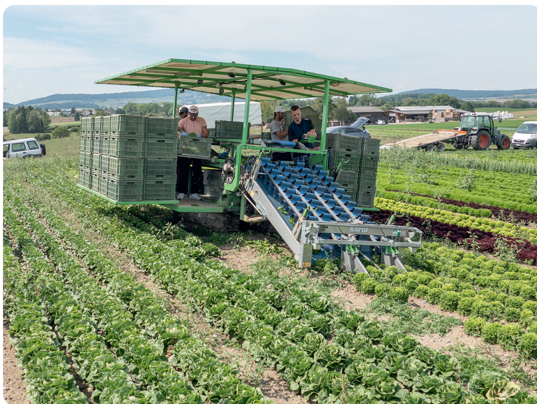
L'Endivia si sposta su cingoli attraverso i campi di insalata e taglia autonomamente i cespi. DAVID EPPENBERGER
