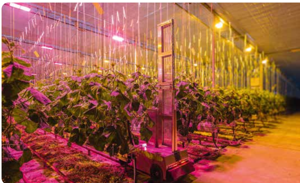
Le Lumion équipé de rayons UVC dans des cultures de concombres.
